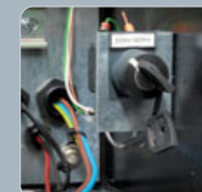
50/60 Hz Proporciona mudar a frequência da energia eléctrica.
